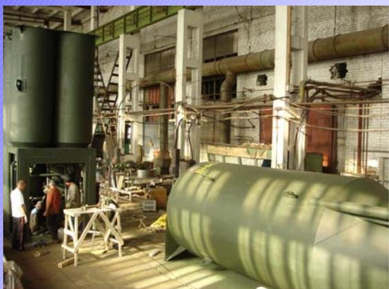
Подготовка очистных сооружений с производительностью 45 куб. м/сутки для отгрузки в Большемуртинский район Красноярского края
