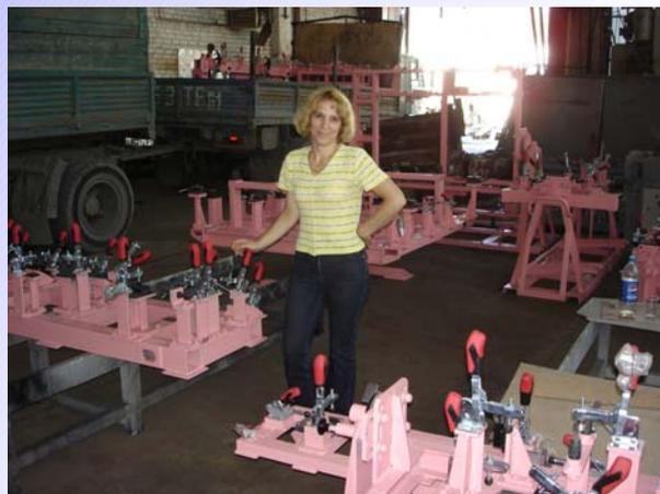
Перед отгрузкой покупателю, на ОАО «ВНИИТМАШ» каждое приспособление проходит жесткий контроль по объектовым деталям и контрольно-установочным размерам.
