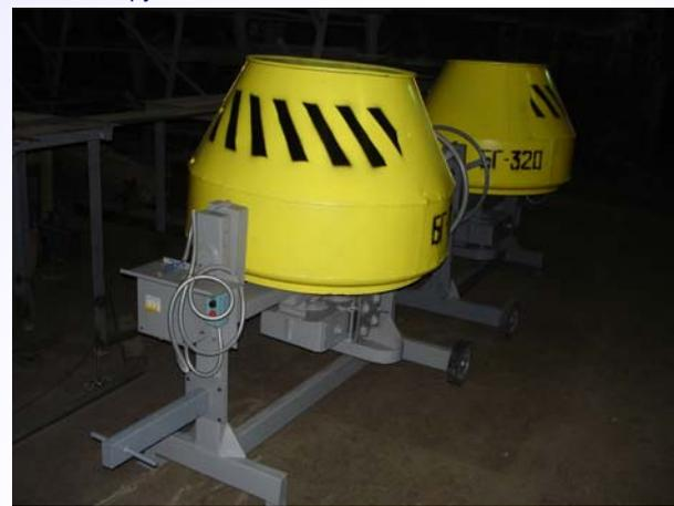
Бетоносмеситель гравитационный, разработанный на ОАО «ВНИИТМАШ», предназначен для приготовления крупнопористого керамзитобетона в условиях полигона.
