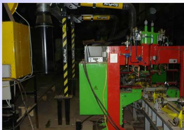
Современная, высокопроизводительная установка автоматической контактной сварки, разработанная специалистами Научно-технического центра ОАО «ВНИИТМАШ» и внедренная в производство в сборочно-сварочном цехе ОАО «ВНИИТМАШ»
