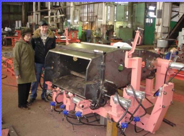
ОАО «ВНИИТМАШ» ежегодно проектирует и изготавливает для ОАО «Ростсельмаш» более 300 сборочно-сварочных приспособлений для механизированной и автоматизированной сборки новых моделей комбайнов.
