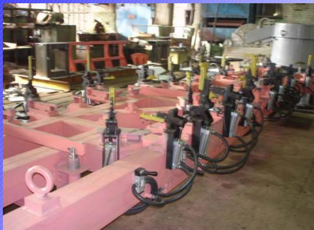
Сборочно-сварочные приспособления ОАО "ВНИИТМАШ" спроектированы для надежной и точной фиксации свариваемых деталей длиной до 12 метров.
