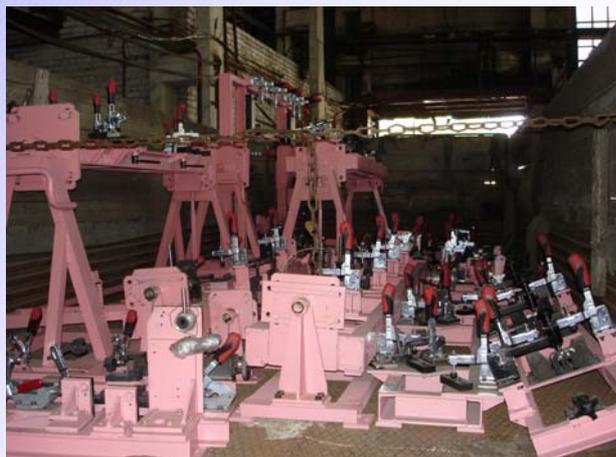
Новые сборочно-сварочные приспособления позволяют многократно позиционировать и закреплять свариваемые детали благодаря использованию запатентованных позиционирующих зажимов AMF и DE-STA-CO.
