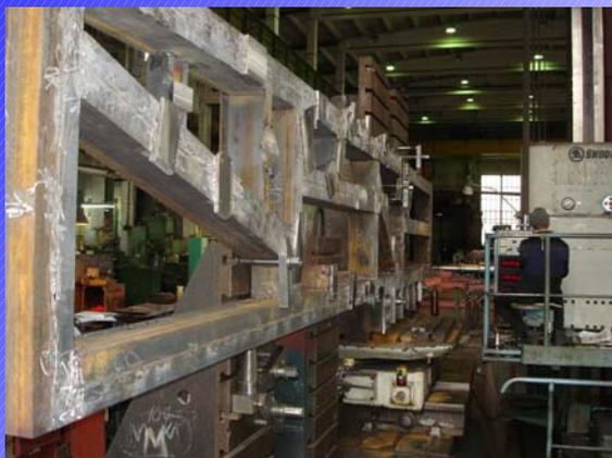
Обработка крупногабаритной технологической оснастки на горизонтально-расточном станке "Sckoda"
