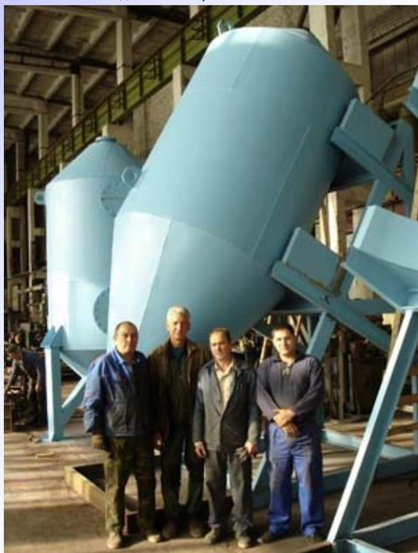
В сжатые сроки ОАО «ВНИИТМАШ» выполняет заказы по изготовлению установок для очистки поверхностных вод на питьевые нужды производительностью до 400 куб м/сутки.
