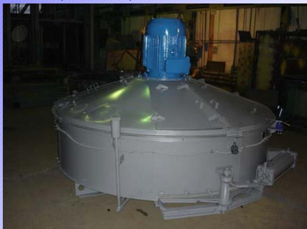
На ОАО «ВНИИТМАШ» разработано и освоено производство высокопроизводительных бетоносмесителей с объемом готового замеса до 1200 литров.
