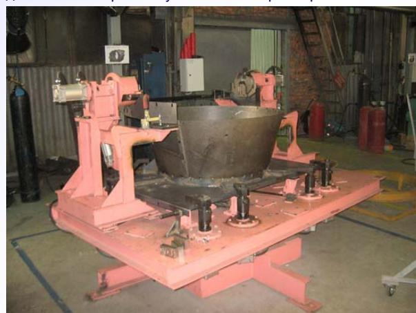
Пневматические и ручные приспособления ОАО «ВНИИТМАШ» работают на программу сборки и сварки деталей комбайна нового поколения.
